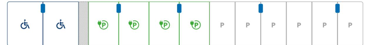
Der C5-x Baukasten ist maximal flexibel. Zwischen 6,3 und 35,6 m Breite kann in 1-Meter-Schritten genau die passende Länge gewählt werden. Die Säulen können dabei flexibel positionierbar werden und erlauben damit eine individuelle Parkplatzeinteilung.
