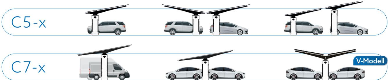
Hochmodulares Überdachungskonzept mit überdachten Tiefen von 5 – 7 m, ideal für klassische PKW oder auch Lieferwägen. Durch die variable Breite in 1-Meter-Schritten und die frei positionierbaren Säulen lässt sich jeder Parkplatz optimal gestalten.
