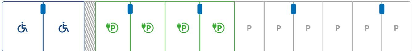
Der C5-x Baukasten ist maximal flexibel. Zwischen 6,3 und 35,6 m Breite kann in 1-Meter-Schritten genau die passende Länge gewählt werden. Die Säulen können dabei flexibel positioniert werden und erlauben damit eine individuelle Parkplatzeinteilung.
