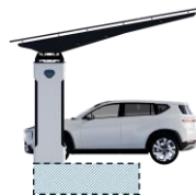
Betonfundamente (Ortbeton oder Fertigteil)
