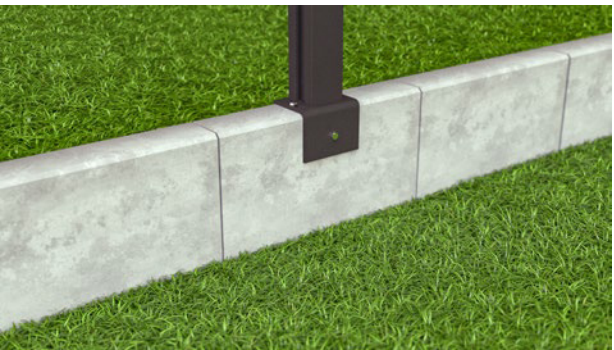
Montage mit L-Stein Fußplatte auf Mauer
