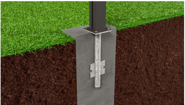
Montage mit Fußplatte auf Erdanker
