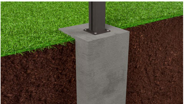
Montage mit Fußplatte auf Fundament
